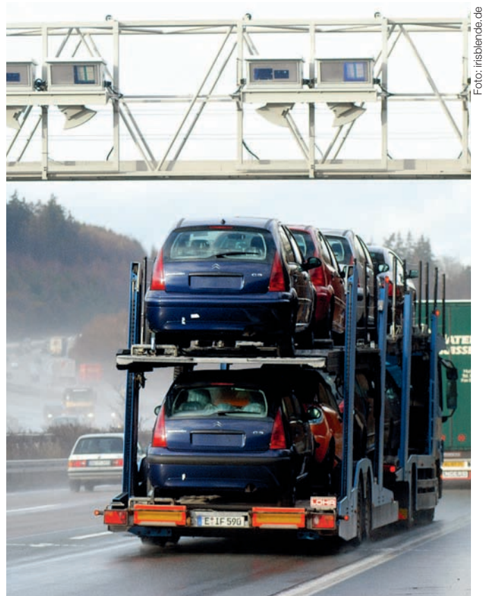
Brummis unterwegs: Kontrollbrücken prüfen automatisch, ob sich ein durchfahrender Lkw in das Mautsystem eingebucht hat.
